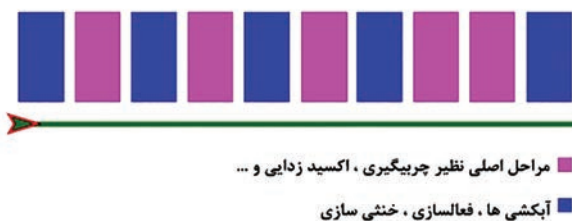
شکل ۶. شماتیکی از چیدمان خط آبکاری در حالت اتوماتیک
